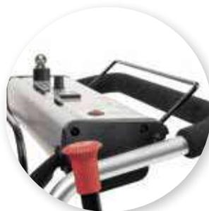
Das Bedienfeld für den Antrieb befindet sich zwecks einfacher Handhabung direkt am Lenker. Der E-Turtle wurde so konstruiert, das nur Erwachsene den Bus in Bewegung setzen können. Stufenlose Geschwindigkeitsregelung ermöglicht Vorwärts- und Rückwärtsfahren.
