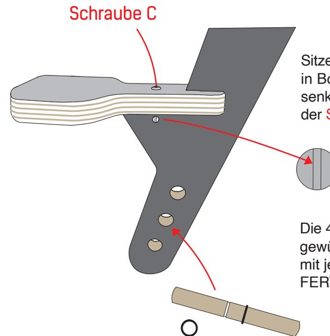
Sitze einschieben. Querbolzenmutter in Bohrung einsetzen - mit Schlitz senkrecht (siehe Abb.) Die Sitze mit der **Schraube C (6 x 50mm)** befestigen.
