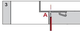
Entfernen Sie die Schutzfolie von dem Klebeband und kleben Sie erst den unteren Teil auf den waagerechten Strich an der Unterseite des Türrahmens. Achten Sie darauf, dass der Rand des Klemmschutzes genau parallel zum Rand des Türrahmens verläuft. Drücken Sie den Klemmschutz kräftig an (siehe Zeichnung 3a, Position A).
