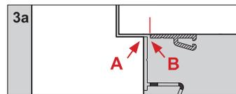
**Achtung:** der Türflügel darf den Klemmschutz, der auf den Türrahmen montiert ist, nicht berühren.
