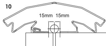
**PIVOTTÜREN (2 BREITE STREIFEN UND 2 BEFESTIGUNGSPROFILE)**
