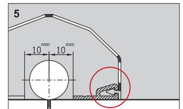
Wenn der Schmale Klemmschutz und das Befestigungsprofil richtig montiert sind, können Sie das Ende des schmalen Klemmschutzes von oben nach unten in das Befestigungsprofil einklicken (siehe Zeichnung 6).
