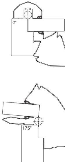
Ziehen Sie einen waagerechten Strich (mit weichem Bleistift) in einem Abstand von 15 mm zur Unterkante des Türflügels und in gleicher Höhe an den Innen- und Scharnierseiten des Türrahmens (siehe Zeichnung 1).
