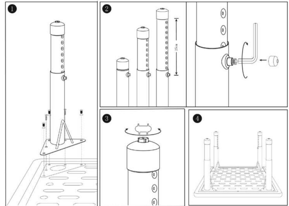
1. Richten Sie die Tischbeine entsprechend den Montagelöchern aus. Schrauben Sie die selbstschneidenden Schrauben und  $\varnothing 6$ -Schrauben mit einem Schraubendreher in die Löcher.
